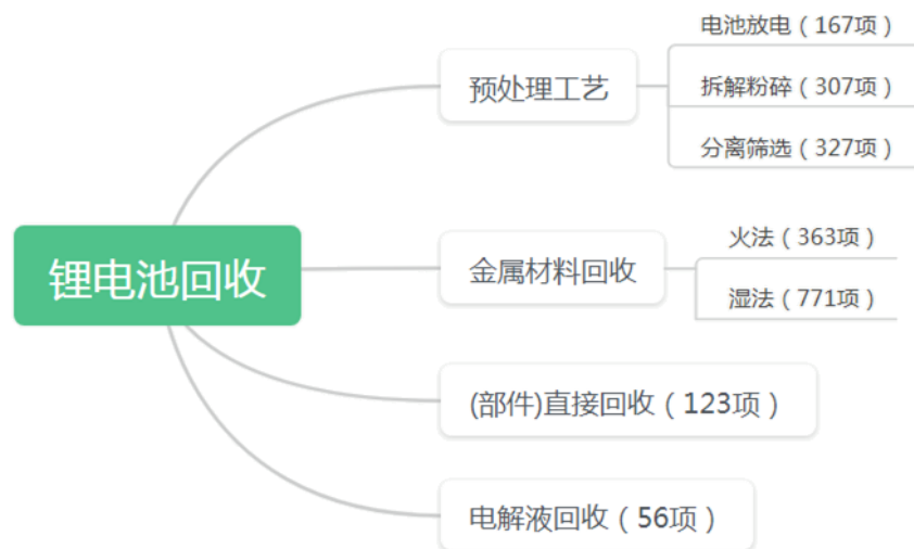
图 10 锂电池回收工艺技术构成
